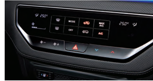
Klima Kontrol Paneli
