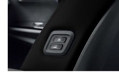
Elektrikli Ön Yolcu Koltuğu Kaydırma Mekanizması
