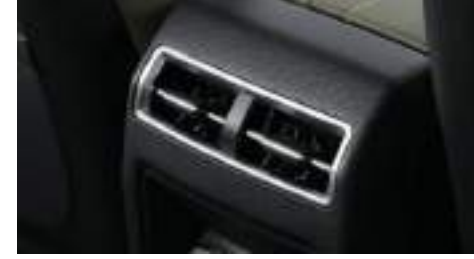
Arka orta konsol havalandırması
